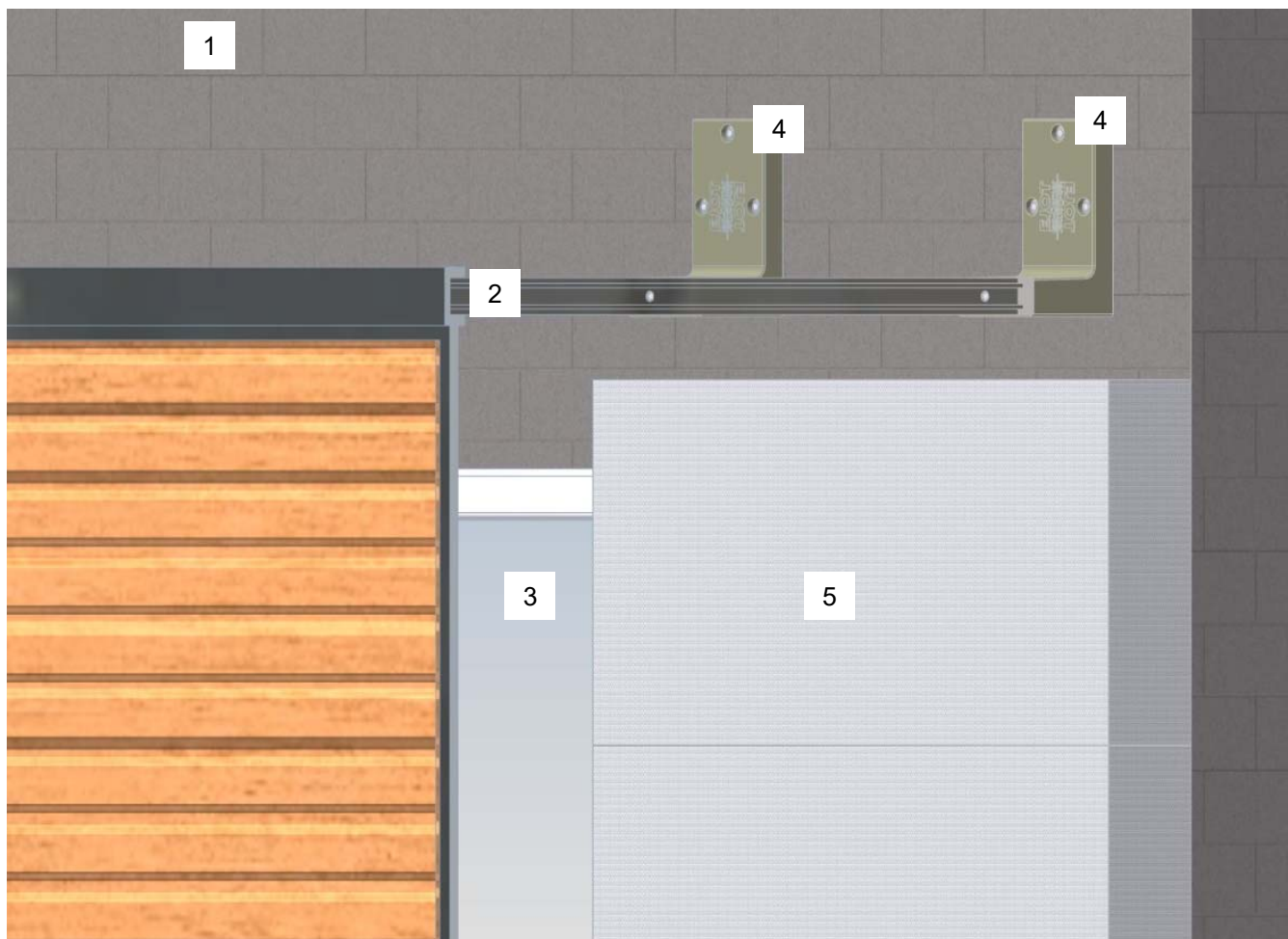
Darstellung 1: Beispiel Einbauzustand Schiebeladen – stirnseitige Montage
