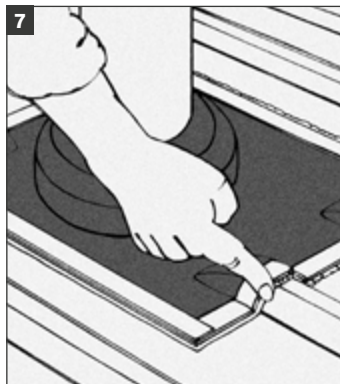
Beigefügte Metallstreifen verwenden um überlappende Enden abzudichten. Eventuell überstehende Seiten weg-schneiden.
