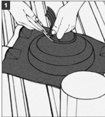
DEKTITE® an Rohr anpassen.
