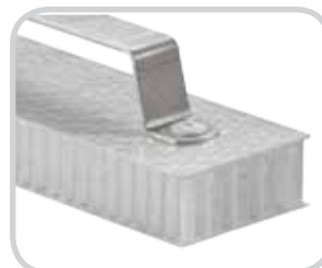
PP-Wabe + PP GF-Deckschicht Auszugskraft 800 N
