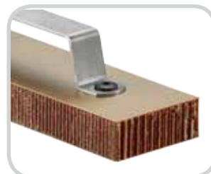
Aramidwabe + Aramidfaser-Deckschicht Auszugskraft 700–1.200 N
