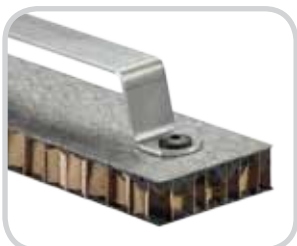
Papierwabe + PUR GF-Deckschicht Auszugskraft 900 N
