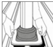
2. DEKTITE® an Profiblech anpassen und markieren.
