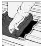
5. Dichtungsmasse auftragen und DEKTITE® formgenau an Profillech anpassen.
