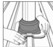
4. DEKTITE® formgenau an Profiblech anpassen.
