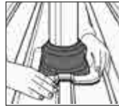
3. DEKTITE® formgenau an Profileblech anpassen.
