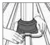
4. DEKTITE® formgenau an Profilblech anpassen.
