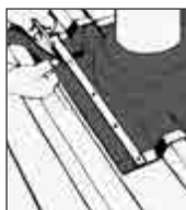
7. Beigefügte Metallstreifen verwenden um überlappende Enden abzudichten. Eventuell überstehende Seiten wegschneiden.
