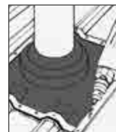
6. Zuerst auf den Seiten mit den Profilrippen befestigen, mittig angefangen. Die restlichen Seiten folgend.
