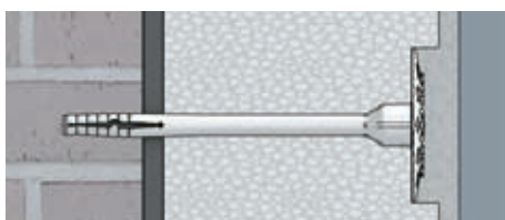
špatně: příliš hluboké zatažení talíře
