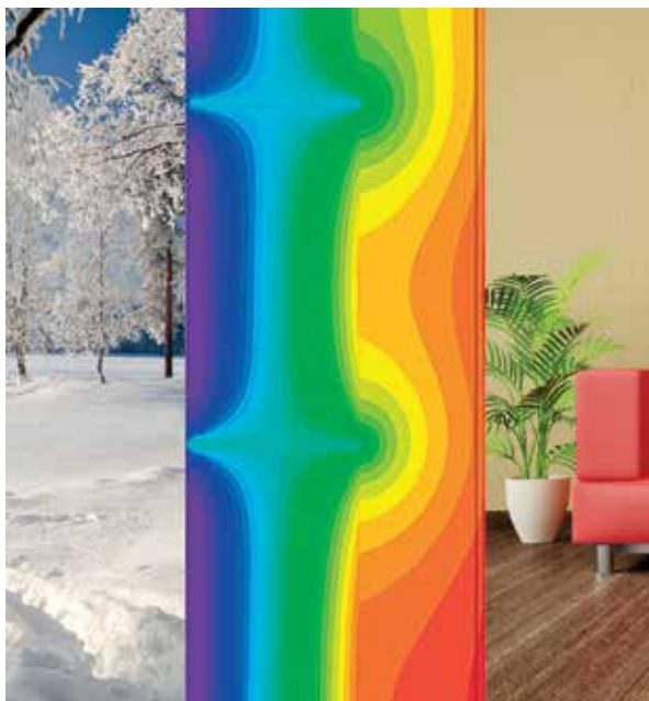
Obrázek 1 Výrazný tepelný most s hliníkovými konzolami
